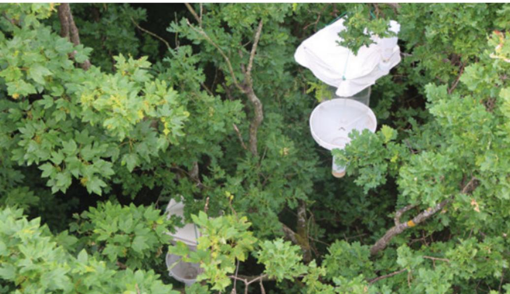
Eine Fensterfalle ist eine in der Forschung eingesetzte Vorrichtung zum Fang von Käfern oder anderen fliegenden Insekten.
